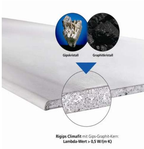
Rigips Climafit ist die weltweit erste graphitmodifizierte Gipsplatte. Die Kombination von Gips und Graphit verleiht der Rigips Climafit eine besonders hohe Wärmeleitfähigkeit von  $> 0,5 \text{ W/(m}\cdot\text{K)}$ . So wird die natürliche Behaglichkeit mit einer hocheffizienten Temperierleistung vereint. Rigips Climafit ist auch als Rigiton Climafit Lochplatte lieferbar.
