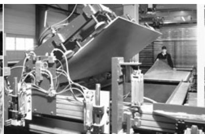
Bild 1.3: Vollautomatisches Heraus- heben der Platten aus den Schalungsformen
