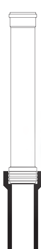
Übergang von POLO-KAL NG-Spitzende auf Faserzement-Muffe
