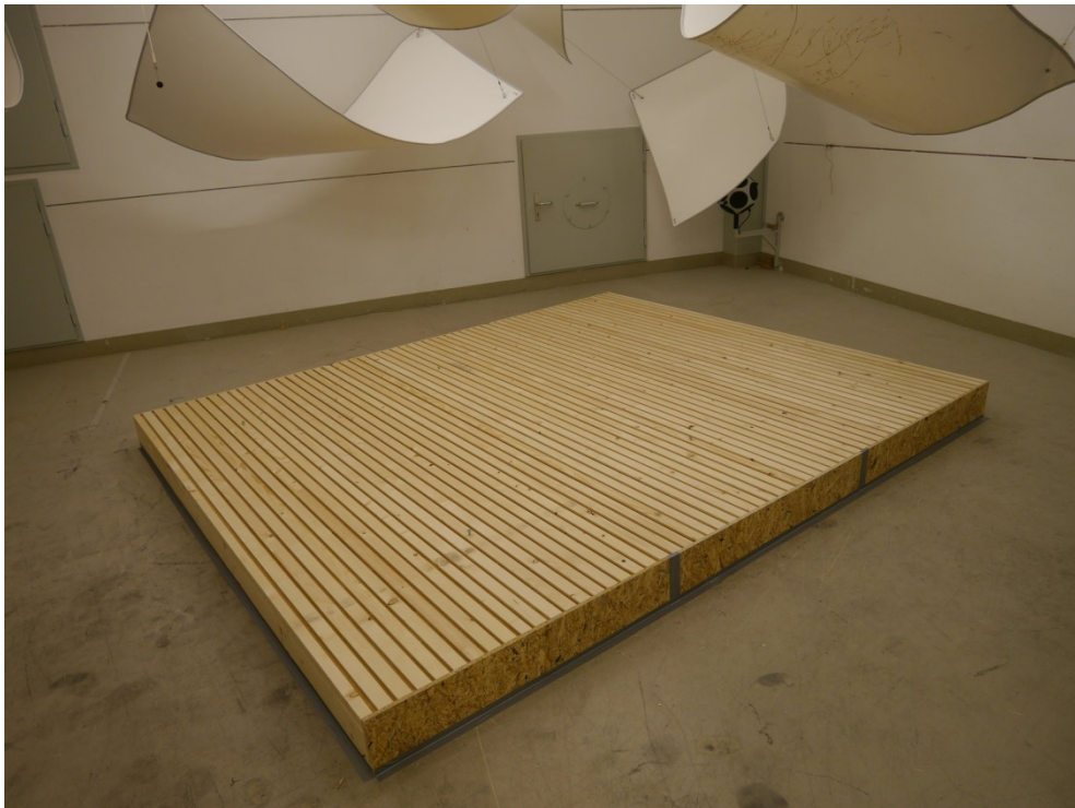
Abbildung B.2. Prüfaufbau im Hallraum (prüffertig).
