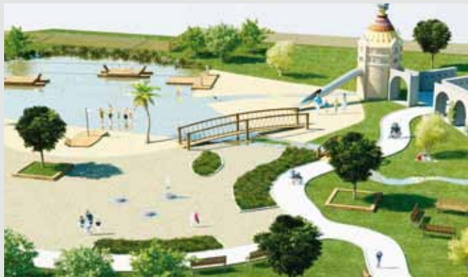
WASSERSPIELPLATZ AM WASSERTURM WIEN, ÖSTERREICH Überdämmung eines Trinkwasserbehälters und Modellierung einer Wasserlandschaft mit Aquädukt, Wasserlauf und Lagune. Folie auf der GEOCELL® Schüttung zur Abdichtung
