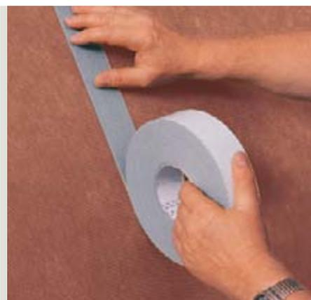
Imprägniertes Schaumstoff-Dichtungsband. Einseitig selbstklebend.
