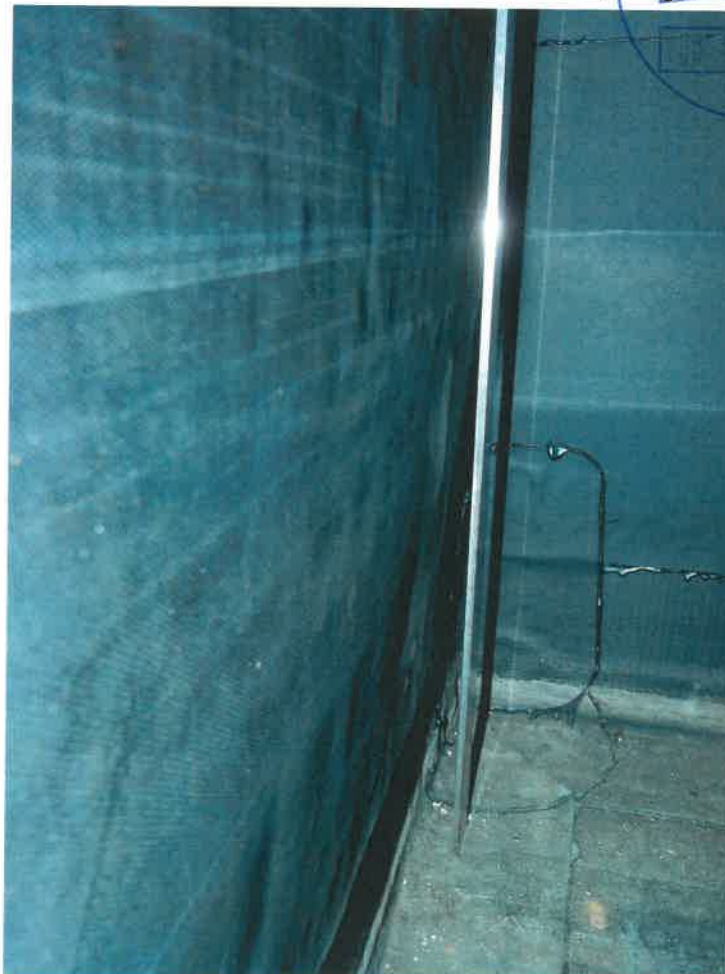
Bild 11: Prüfung der Druckwasserdichtigkeit bei 2 bar und einer resultierenden Verformung von 24,7 mm (2. Verformungsstufe)
