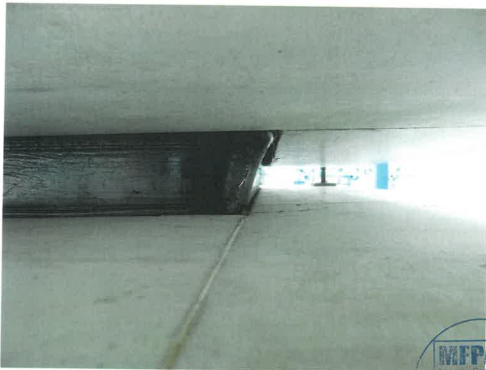
Bild 13: Fugenraum nach Eintrag der 3. Verformungsstufe mit geringfügiger Ablösung der Bahn am Rahmen
