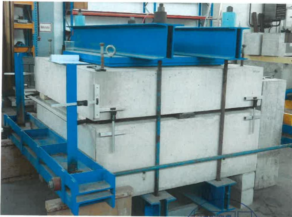
Bild 11: Prüfung der Druckwasserdichtigkeit bei 2 bar und einer resultierenden Verformung von 24,7 mm (2. Verformungsstufe)
