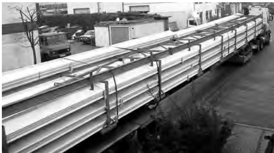
Abb.: Dachprofile-Transport mit einer Traverse zum Entladen
