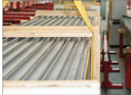
Abb. 03 Distanzholz oben im Bereich des Hebegurtes
