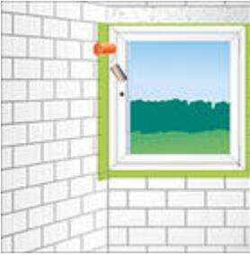
Bild 10: Folie mit Andruckroller anrollen
