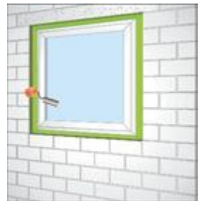
Bild 8: Folie mit Andruckroller anrollen
