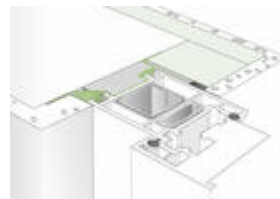
Bild 6: Befestigung der Folie innen wie Außenseite
