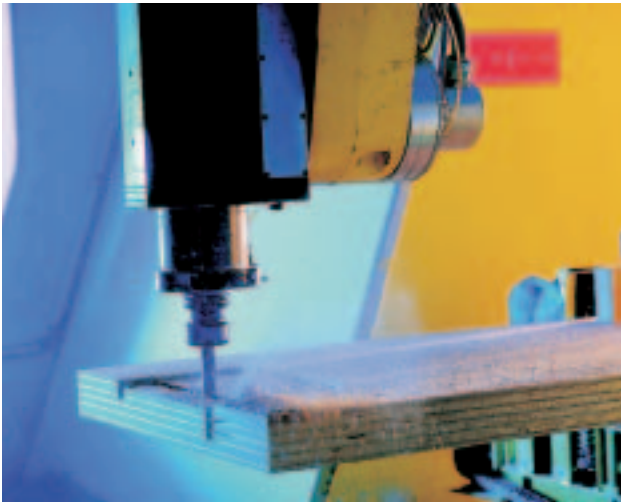
Mit einem Fingerfräser werden Aussparungen in eine Kerto®-Q-Platte eingearbeitet.
