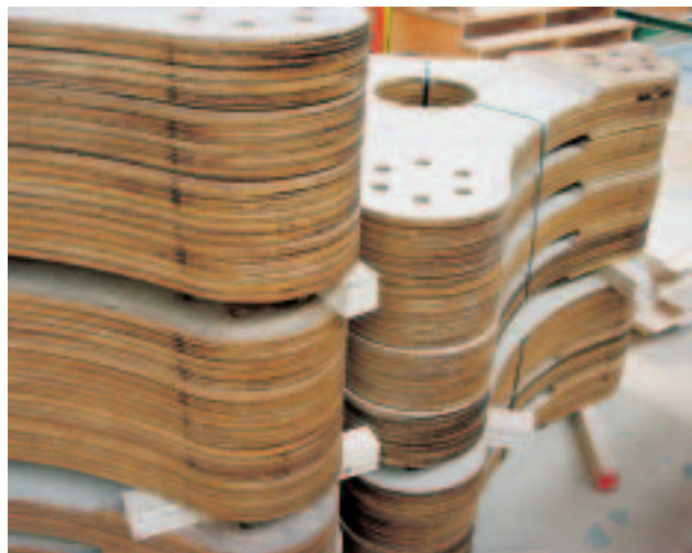
Plattform für Funkmasten, Kerto®-Q verleimt, KD-imprägniert und auf Format geschnitten, gefräst und gebohrt.
