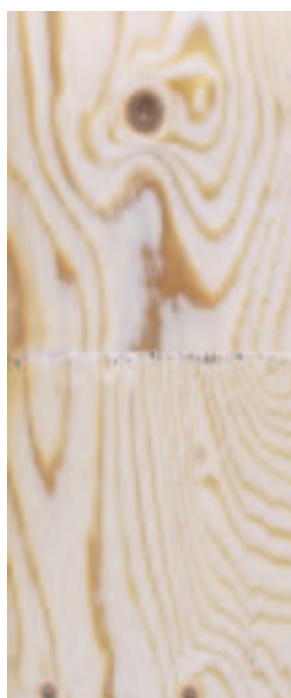
Vorderseite, geschliffen, 60er Körnung (Typ 02/15)
