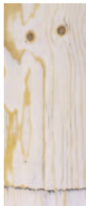
Rückseite, geschliffen, 60er Körnung (Typ 02/16)
