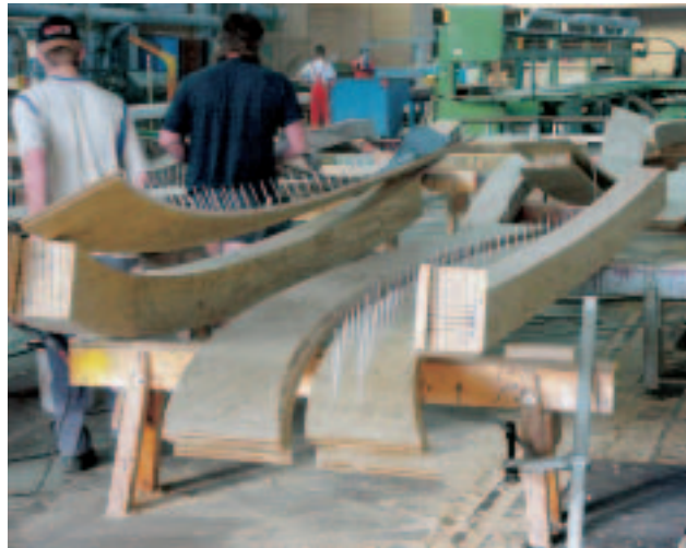
Dreidimensional gefräste Kerto®-Teile – verleimt.
