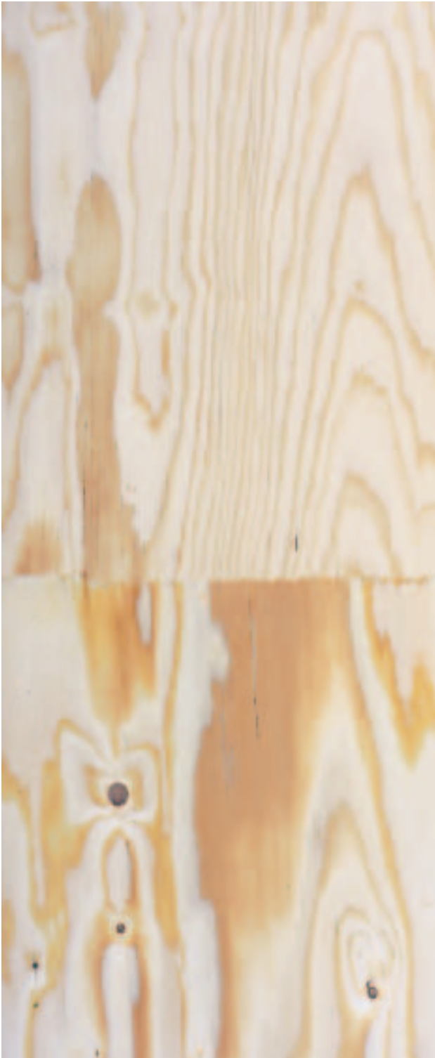
Vorderseite, geschliffen (Typ 04/15)
