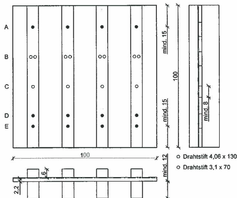
Abbildung 1: Darstellung des Elementes zur Prüfung der Nageldichtheit.
