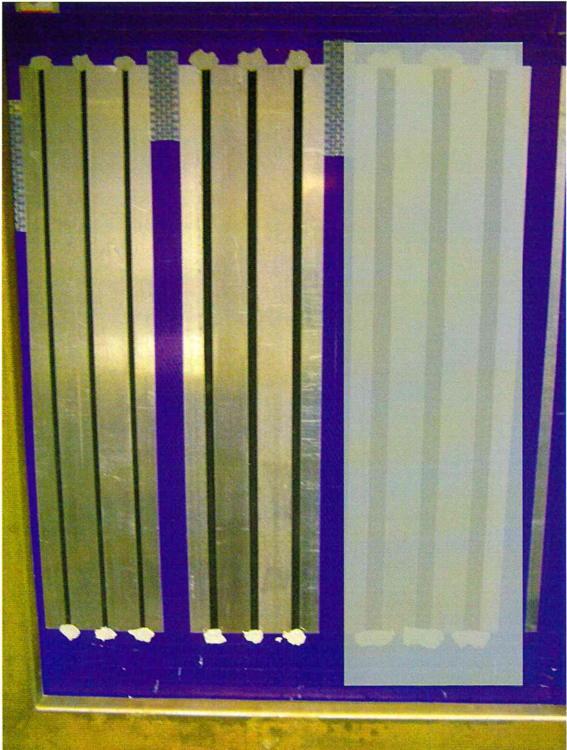
Bild 4: Versuchskörper mit den eingebauten Fugendichtungsbändern (Blick auf schlagregenbeaufschlagte Seite)
