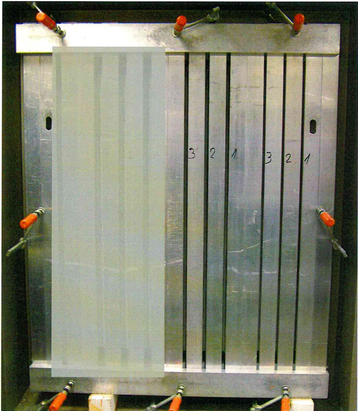
Bild 5: Versuchskörper, bestehend aus Hohlkammerprofilen (Querschnitt 60 mm x 100 mm) mit dazwischen befindlichen Fugen, in denen die Multifunktionsbandproben eingebaut sind.
