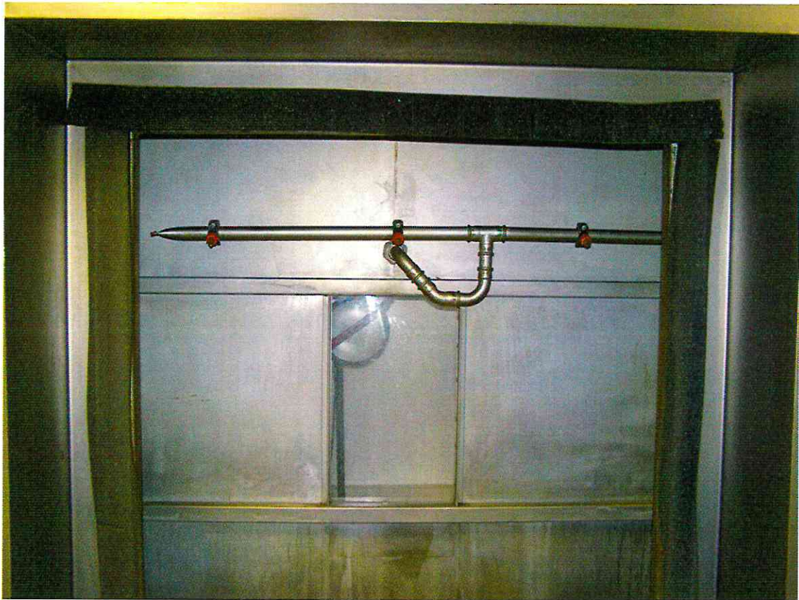
Bild 2: Offener Prüfstand mit Anordnung der drei wassersprühenden Düsen
