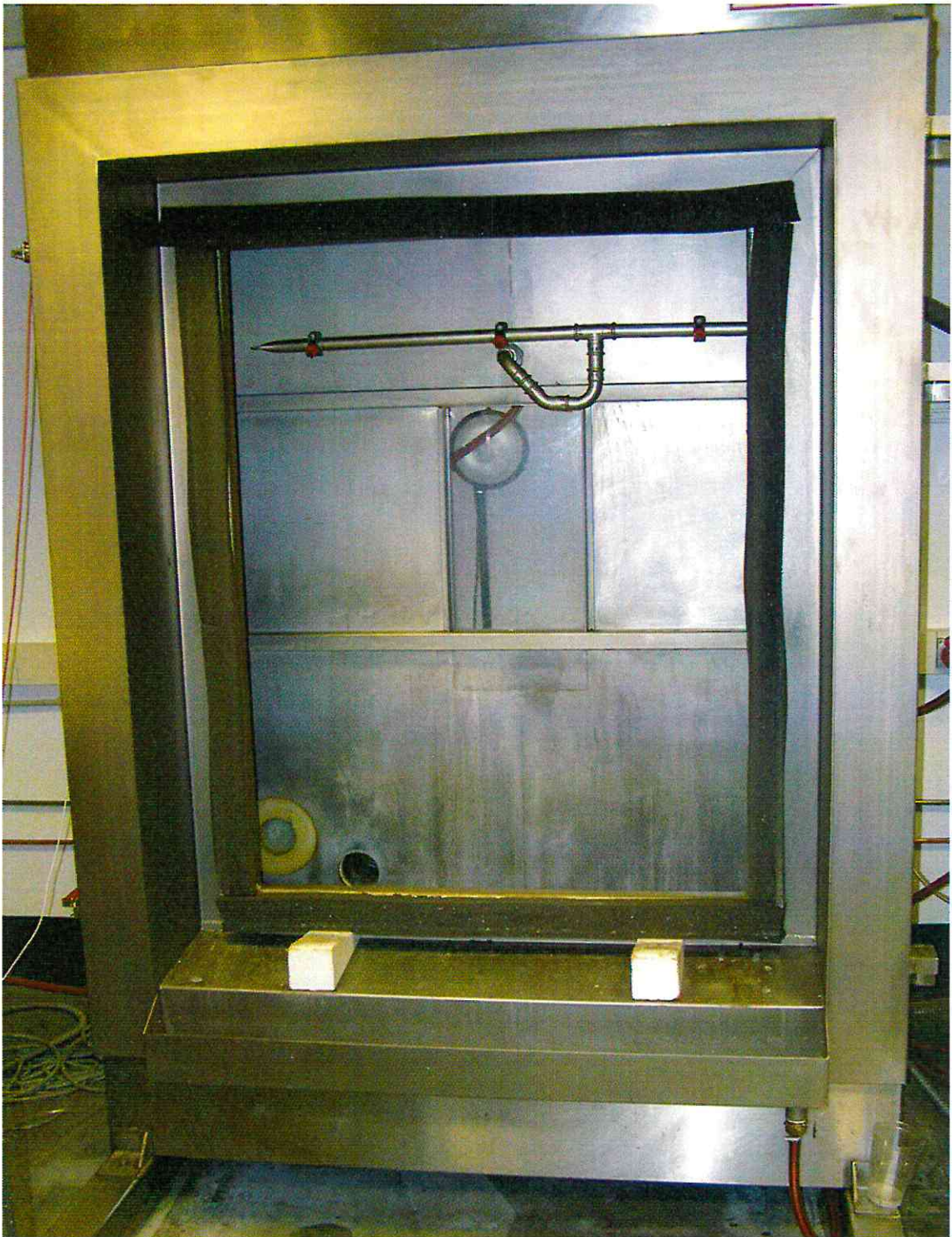
Bild 1: Offener Prüfstand ohne den eingesetzten Versuchskörper
