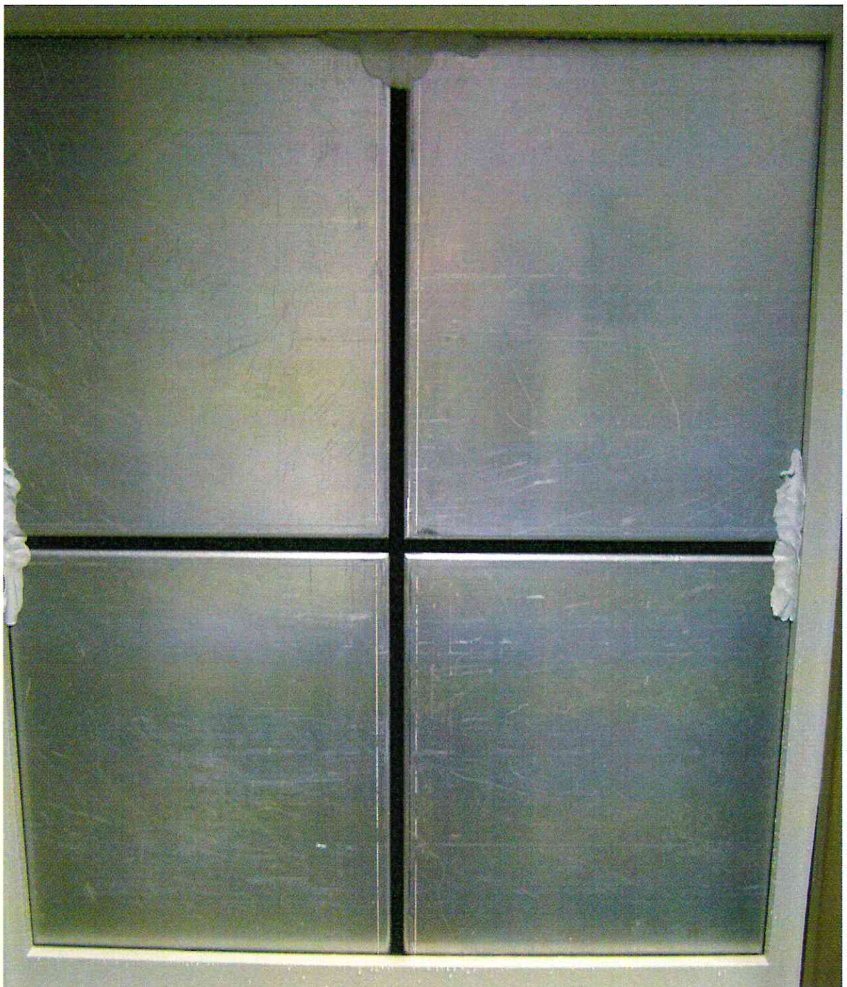
Bild 7: In den Versuchsstand eingebauter Prüfkörper mit dem in 15 mm breiten Fugen eingebauten Fugendichtungsband
