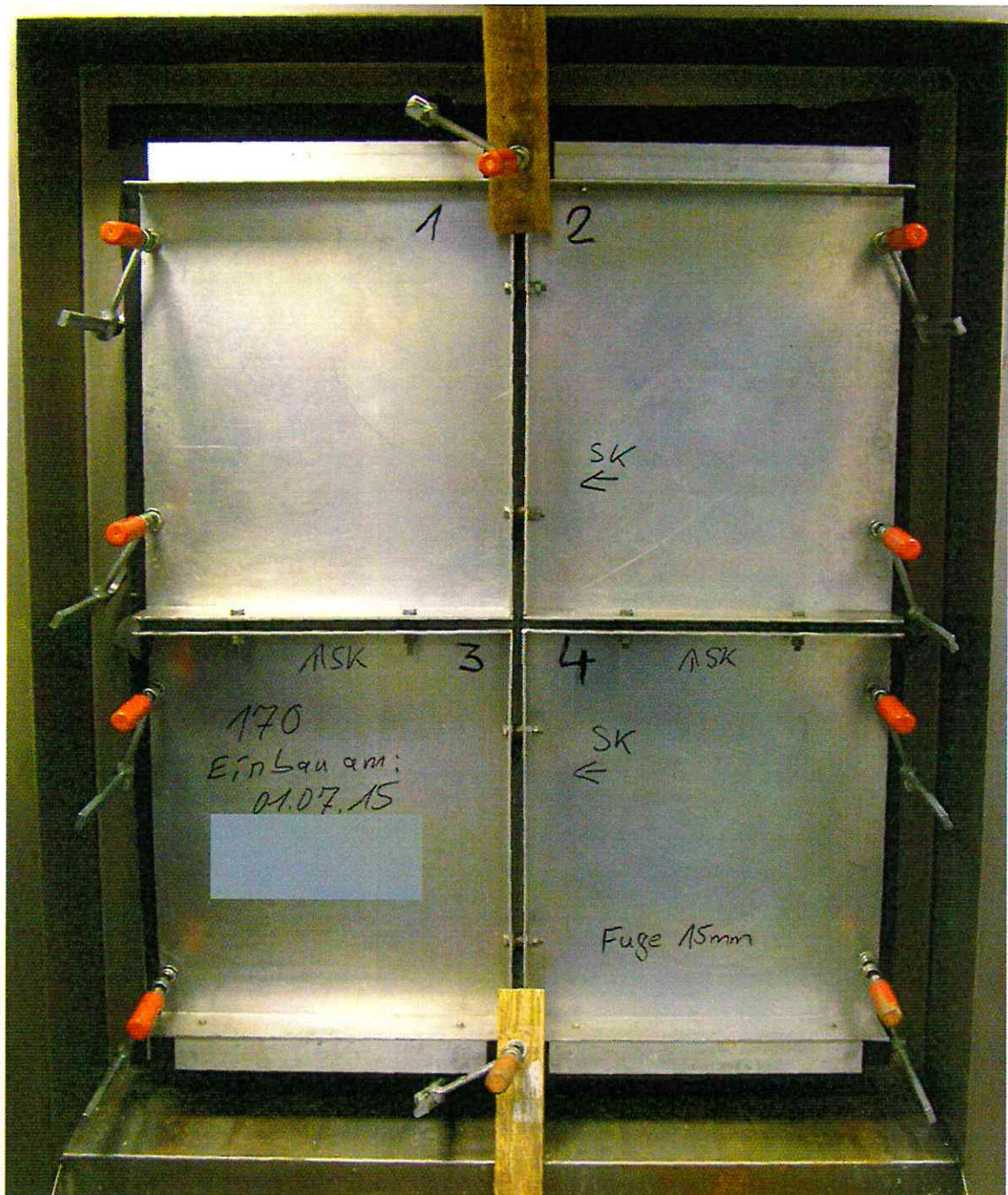
Bild 8: In den Versuchsstand eingebauter Prüfkörper mit dem in den 15 mm breiten Fugen eingebauten Fugendichtungsband
