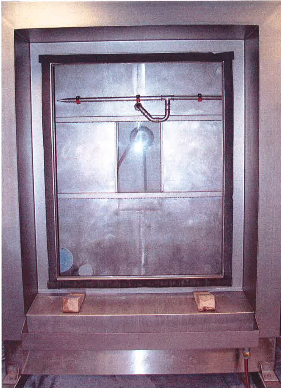
Bild 1: Offener Prüfstand ohne den eingesetzten Versuchskörper
