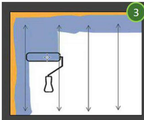
Zurollen der Fläche mittels großer Farbwalze (z.B. Polyamid / Storch DuraStar). Hierzu sollten ca. 4 Bahnen überlappend vorgelegt werden.
