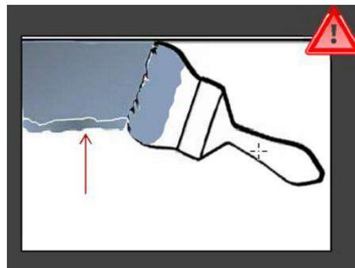
Beim Beschneiden mit dem Pinsel ist darauf zu achten, dass keine Fettkante stehen bleibt. Der Übergang in die Fläche ist gut zu verschleifen.
