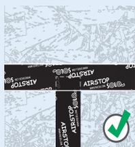
Loses Ende (unten) kann mit einem durchlaufenden AIRSTOP SOLO fixiert sein.
