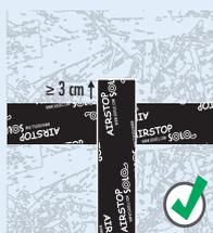
AIRSTOP SOLO kann  $\geq 3$  cm über das untere Band weitergeführt werden.
