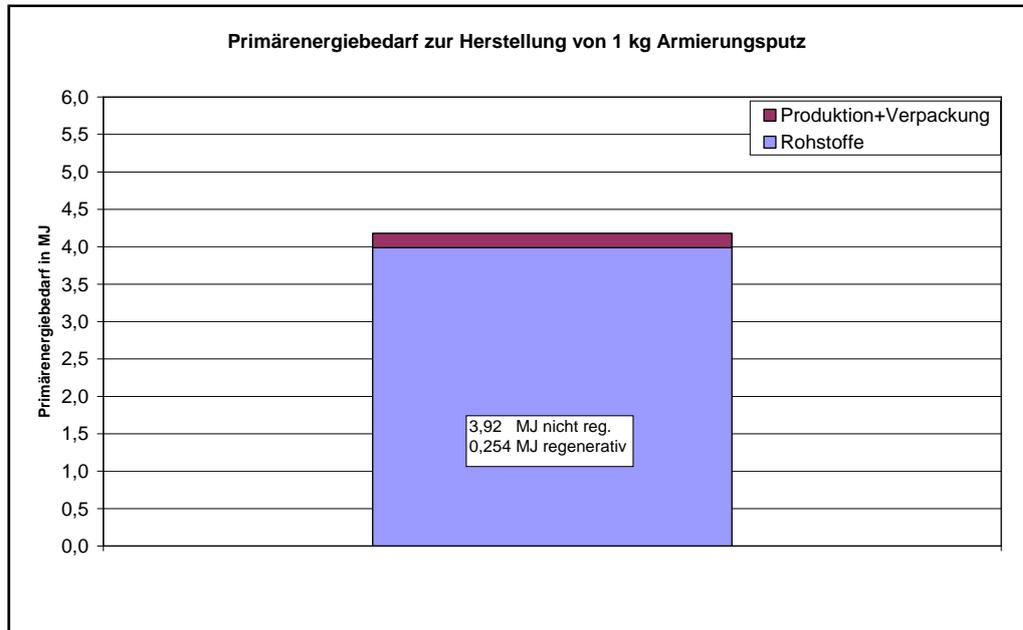
**Abbildung 1: Primärenergiebedarf zur Herstellung von 1 kg Armierungsputz**
