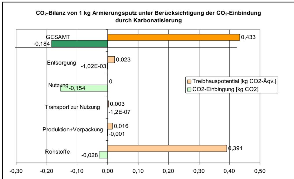
**Abbildung 5: CO<sub>2</sub>-Bilanz von 1 kg Armierungsputz unter Berücksichtigung der CO<sub>2</sub>-Einbindung durch Karbonatisierung**
