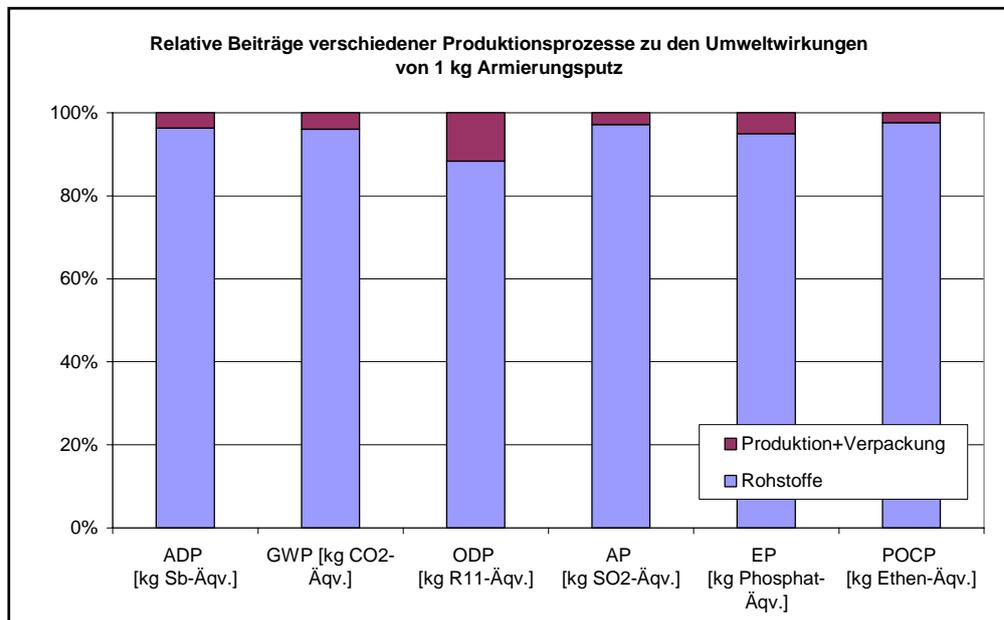
**Abbildung 4: Relative Beiträge verschiedener Produktionsprozesse zu den Umweltwirkungen von 1 kg Armierungsputz**
